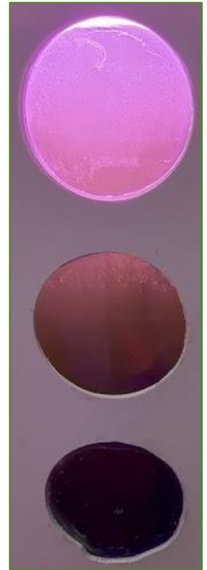
Abbildung 2: Abnahme Lichtintensität mit zunehmender Tiefe (Quelle: eigene Abbildung)
